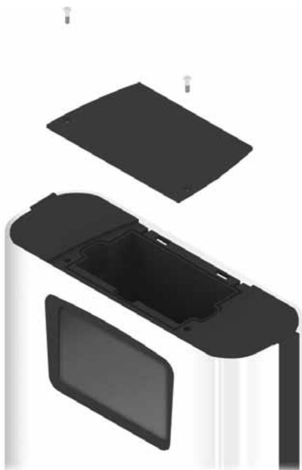
3. Coloque la batería dentro del compartimento. En el interior del sistema hay símbolos + y - marcados en el material, lo cual le ayudará a orientar la batería correctamente. La terminal roja de la batería deberá estar mirando al +, y la terminal negra deberá mirar al -.
