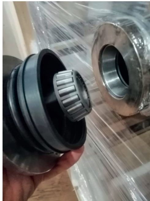
5. Montaje de base inferior y balero
